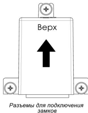
Рис.4. Установка блока управления
